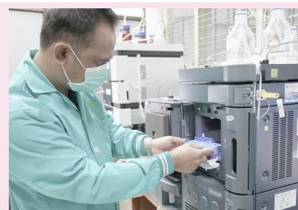
Gambar. Teknisi memasukan sampel LC-MS/MS
