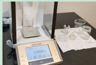
Gambar. Timbangan semimikro resolusi 0,00001 gram
